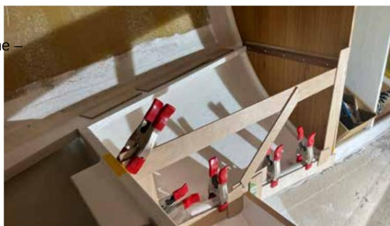
Fremstillingen av former, Kurvene ble fulgt med små klosser. Skottene er vinkelrett på hjertet - båtens linje.
