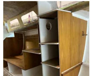
November 2025: Installasjonen tar form. Kjøleren monteres. Skummet mellom laminaten er tydelig synlig i skapet. Foto: Jasper Sterrenburg.
